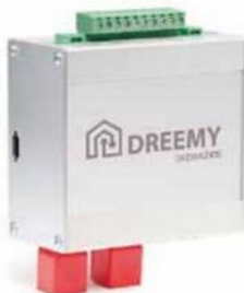
Účelné sdílení elektřiny z vlastní fotovoltaiky umožňuje například nadřazený řídicí systém Dreemy. DZ Dražice
