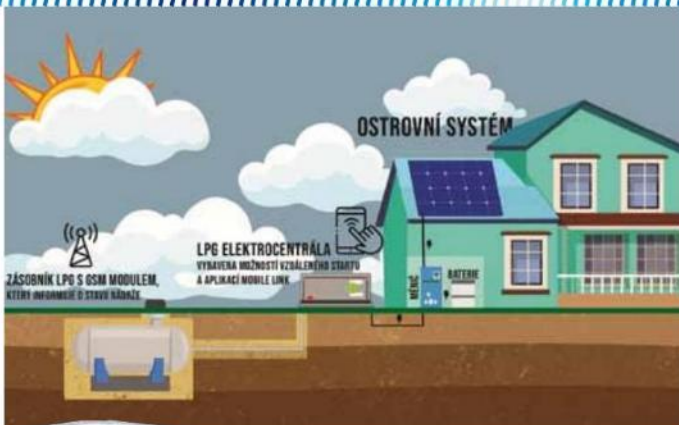
Schéma fungování hybridního systému, který umožňuje kombinovat ostrovní fotovoltaiku s baterií a LPG zásobník. Primagas
