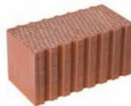
Tepelněizolační broušené cihly Family 50 2in1 (HELUZ) vyplněné expandovaným polystyrenem jsou určeny pro chráněné jednovrstvé obvodové zdivo téměř nulových a pasivních budov, www.heluz.cz
